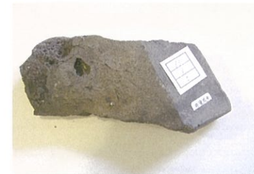
平瓦 火災で長時間高温となり瓦の成分がガスとなり蒸しパン状となっている。
