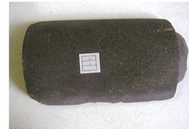
丸瓦 原爆の熱線で瓦の表面が溶けて粒状になっている。
