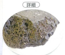
平瓦 火災で長時間高温となり瓦の成分がガスとなり蒸しパン状となっている。
