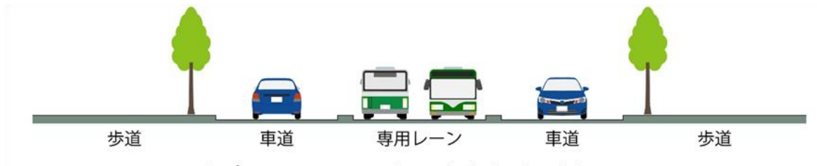
▲バス専用レーン設置（BRT運行）案の断面イメージ （道路中央側に専用レーンとした場合）
