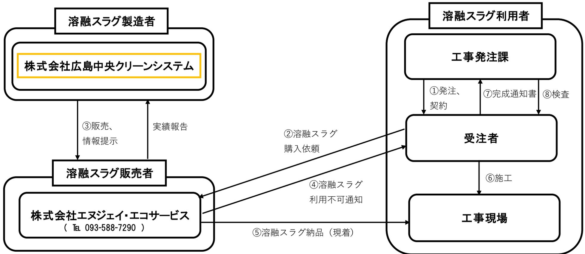
※: ①工事発注者は、溶融スラグ供給対象範囲において、発注工事の材料(再生砂等)を溶融スラグで設計する。
