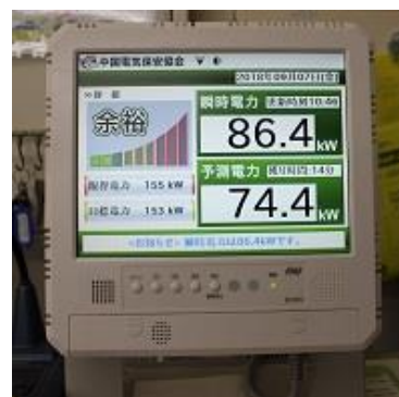
全事業所に設置のデマンドコントローラ
