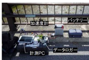
センサーを活用した たわみ計測
