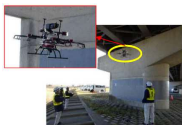
ドローンにより写真撮影し 画像から損傷を確認
