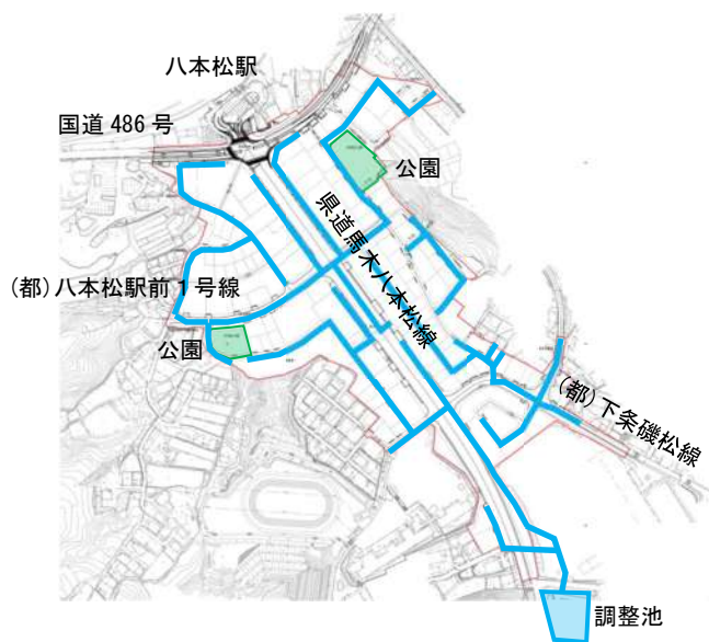
雨水排水施設
