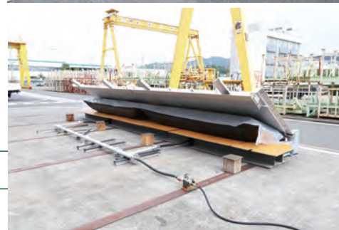
ゴム袋式鋼製堰
