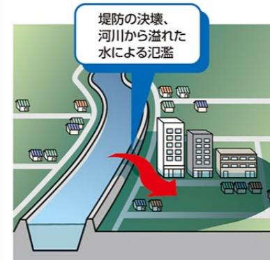
大雨によって河川の水位が高くなり堤防を越えて水が溢れたり(溢水)、堤防が壊れたり(決壊、破堤)する場合があります。このような河川が原因で地域が浸水することを「外水浸水」と呼びます。
