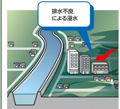
降った雨は水路などを通つて河川に放流されます。しかし、近年雨の降り方が局的に激しさを増しており水路などの排水施設の能力が追いつかず排水できないことがあります。このように降った雨が河川にたどり着く前に地域で溢れて浸水する状態のことを「内水浸水」と呼びます。
