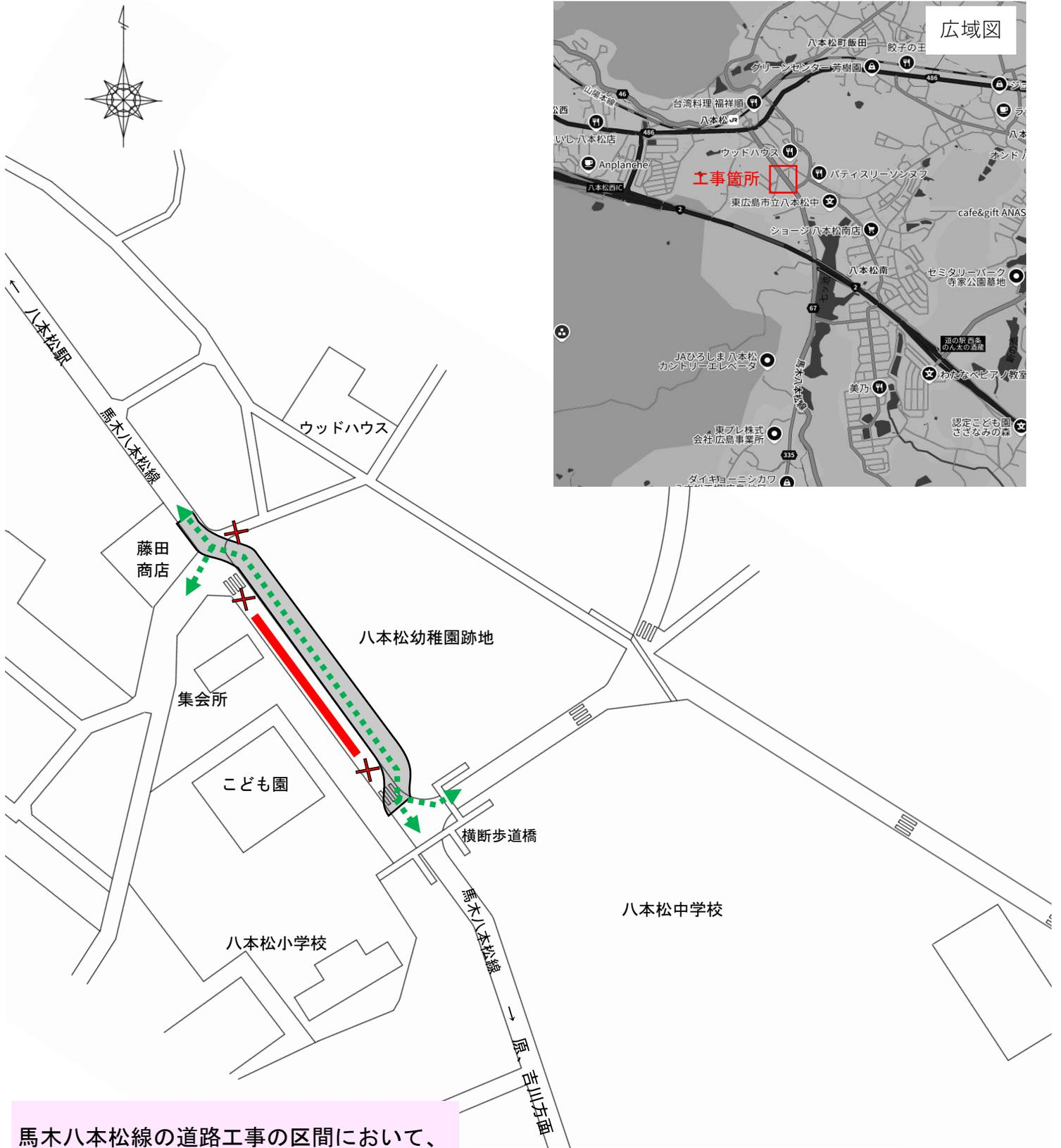
馬木八本松線の道路工事の区間において、図のように仮設道路（迂回路）を設置します。仮設道路への切替えの際に、工事区間において、一時的に片側交互通行（9:00～16:00）を行うことがあります。その際は誘導員がご案内します。
