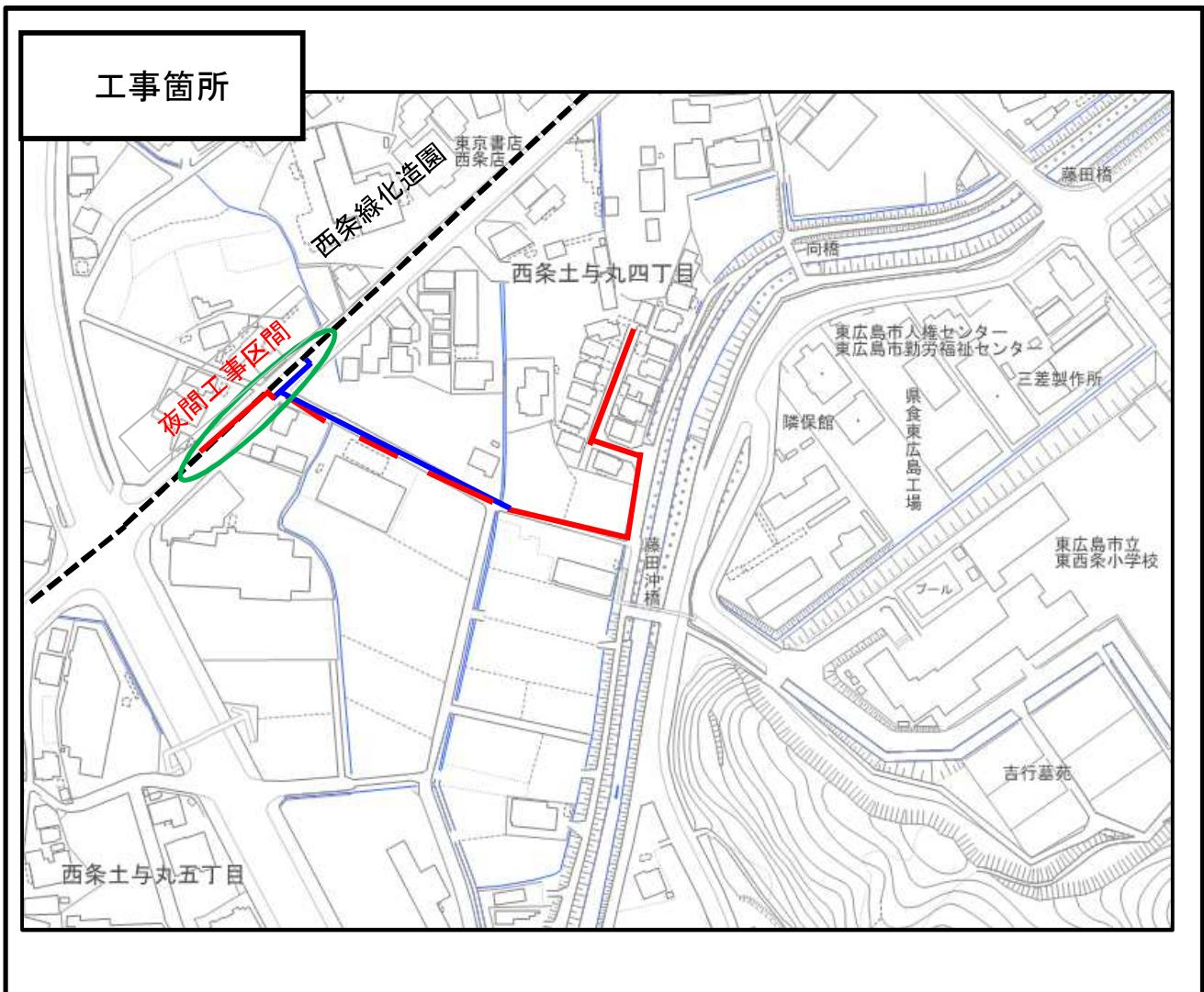
——— 開削工法で汚水管渠(自然流下管)を埋設する箇所
