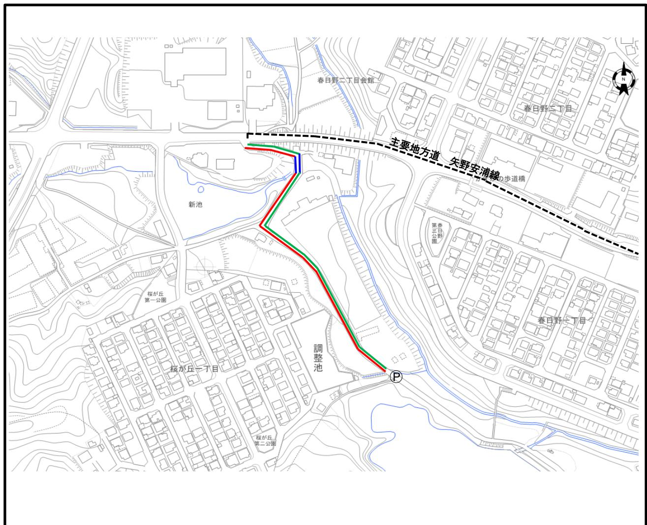
赤線：開削工法で汚水管渠(自然流下管)を埋設する箇所
