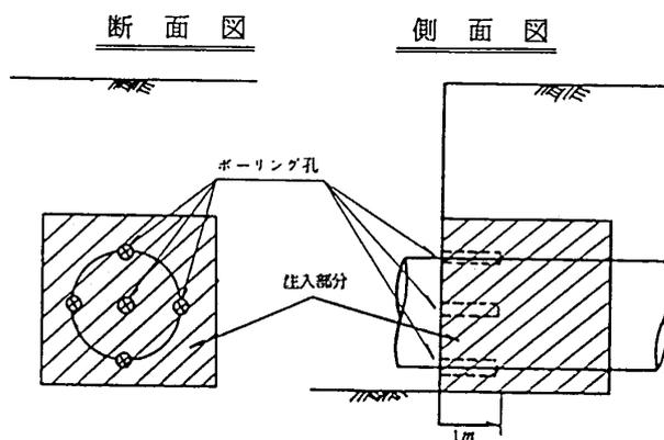
iii) 底盤改良工（鉛直ボーリング）
