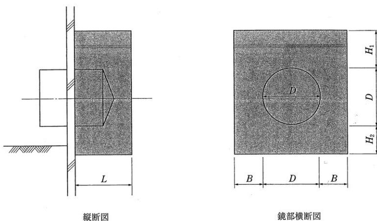
図 2-13 管路布設の場合の最小改良範囲の一例 (発進部・到達部などの鏡切り部)
