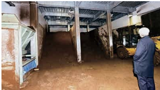
東御市生ごみリサイクル施設「エコクリーンとうみ」二次発酵槽
