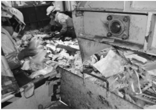
賀茂環境センター(リサイクルプラの選別作業現場)
