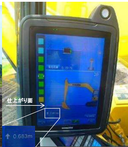
【ICT建機のバックホウの液晶画面】 画面に施工目標と自機の状態表示を行っている。
