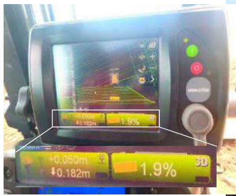
【ICT建機のブルドーザの液晶画面】 画面施工目標と自機の状態表示を行っている。 MC(マシンコントロール)の場合は、オペレータは前後進のみの操作で、ブレードは自動で上下する。
