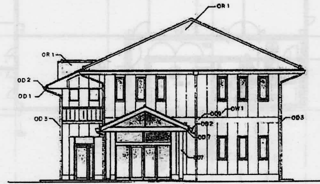
西面立面图 SCALE 1:100
