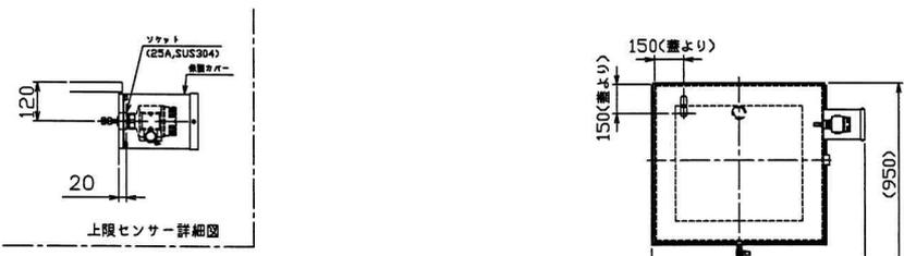
廃油タンク(約485L, t2 SUS430): 850<sup>W</sup>×800<sup>D</sup>×710<sup>H</sup>(mm)
