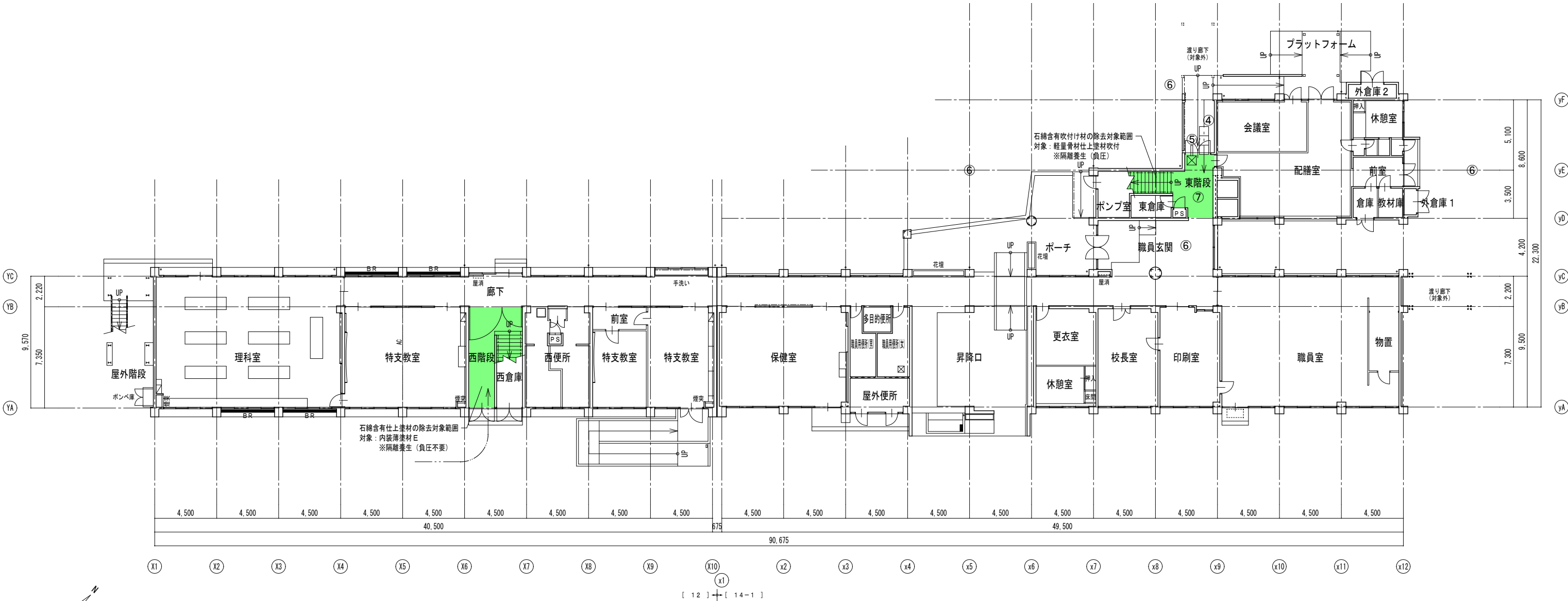
1 階仮設計画図（アスベスト処理） S=1/200
