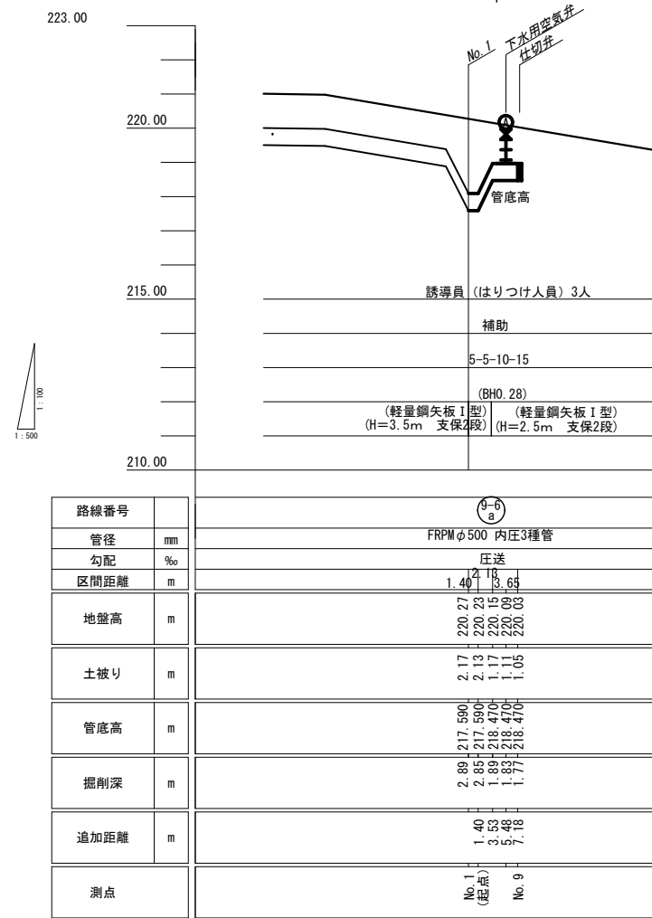
縦断面図 V=1:100 H=1:500 (新設管)
