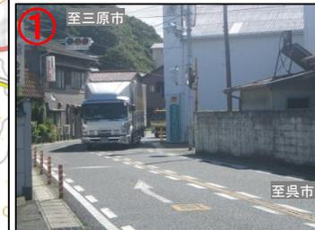
① 道路幅員が狭く、カーブが急なため、反対車線にはみ出して走行している。
