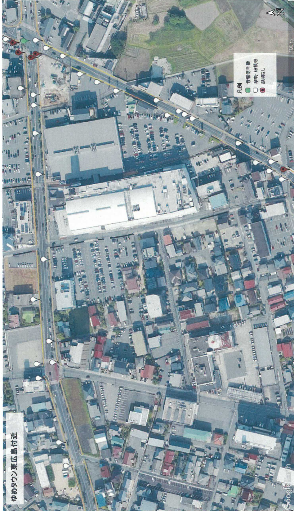
図 3 4 ゆめタウン東広島付近の誘導用ブロック (現地調査をもとに作成)
